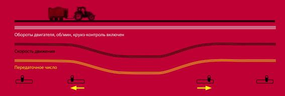
Ручной режим можно выбирать в рабочих диапазонах А и В. Передаточным числом трансмиссии управляет только водитель, используя для этого рычаг CVT. Особенно удобен при уборке урожая, когда требуется определенная скорость движения для различных условий и культур.
