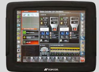
**Опция 2. Система X18 Apollo™** представляет собой упрощенную версию системы X35 Apollo с монитором диагональю 17,8 см но без функции приема и передачи данных и работы по вариативному внесению продуктов на основе карт.
