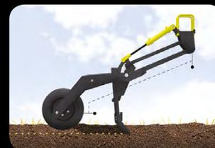
Нижний рычаг сошника находится на одной линии с прикатывающим колесом и точкой крепления к раме.
