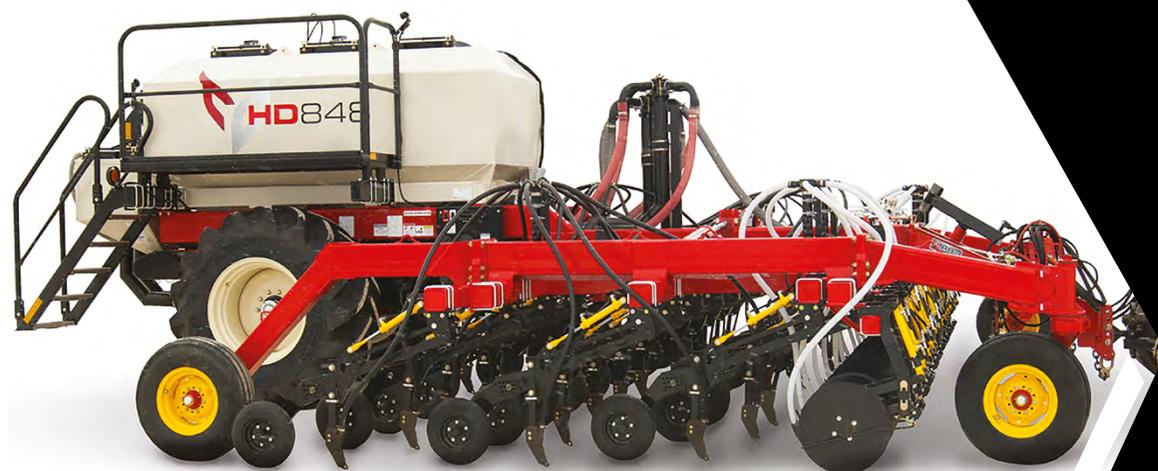
Посевные комплексы серии FMS с анкерными сошниками обеспечивают превосходное копирование контура поля даже при посеве на небольшую глубину благодаря параллелограммной конструкции рычага с пропорцией работы 2:1.
