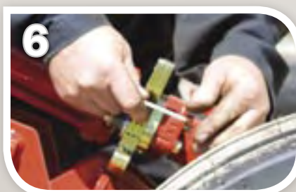
Верните стопорный штифта на место для фиксации установленного количества прокладок.
