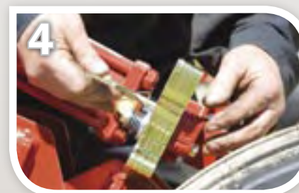
Снимите стопорный штифт с регулировочных шайб.
