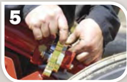
Установите желаемое количество регулировочных прокладок.
