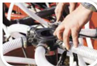
Манифолды с полиуретановой внутренней поверхностью и возможностью быстрого доступа для очистки при забивании.
