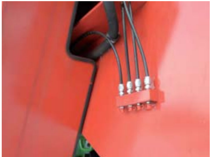
Фотография: Простой доступ к точкам смазки
