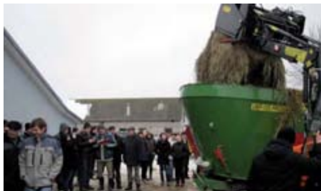
Фотография: Резчик силоса WK-1.5EW с погрузчиком PRONAR LC-3, используется для транспортировки компонентов к кормораздатчику.
