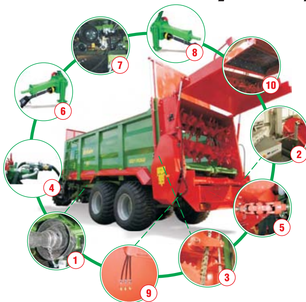
Фотография: Разбрасыватель N161 оборудован горизонтальным адаптером с прикручиваемыми лопатками
