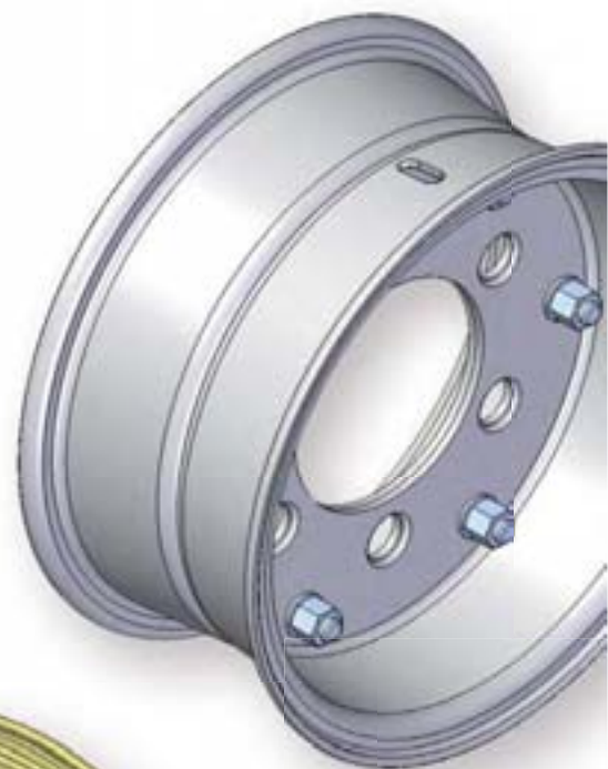
Рис. 5: Разделенное свинчиваемое колесо
