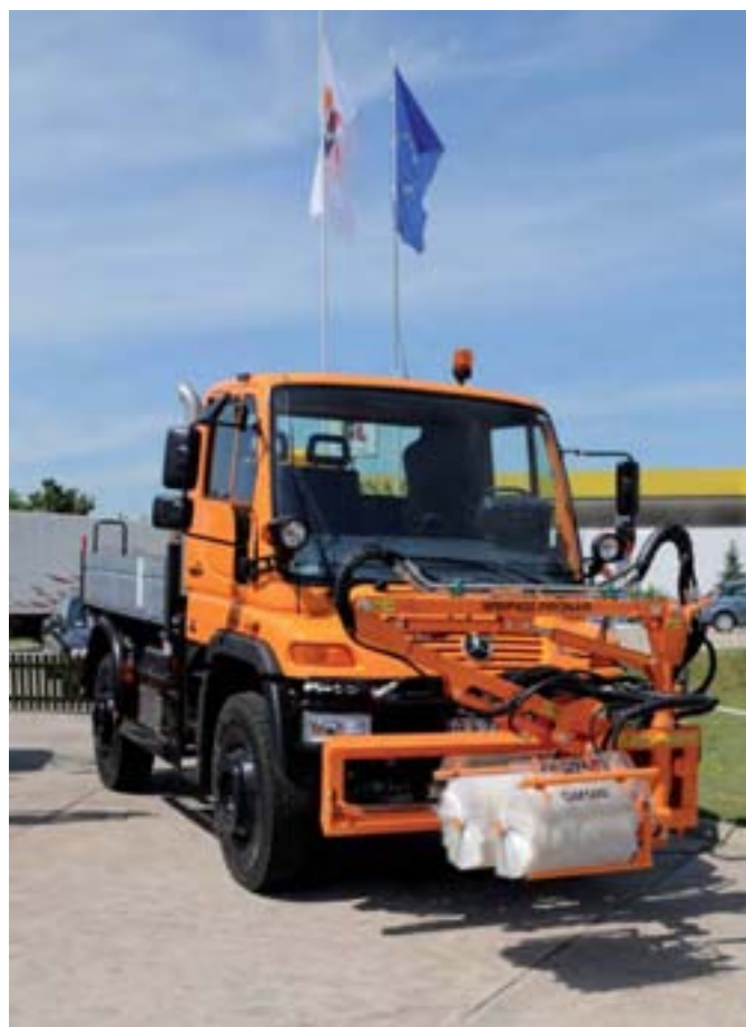
Фотография: Многофункциональная консоль Pronar WWP400, агрегированная с мойшей головкой для знаков Pronar GM500, на машине Mercedes Unimog
