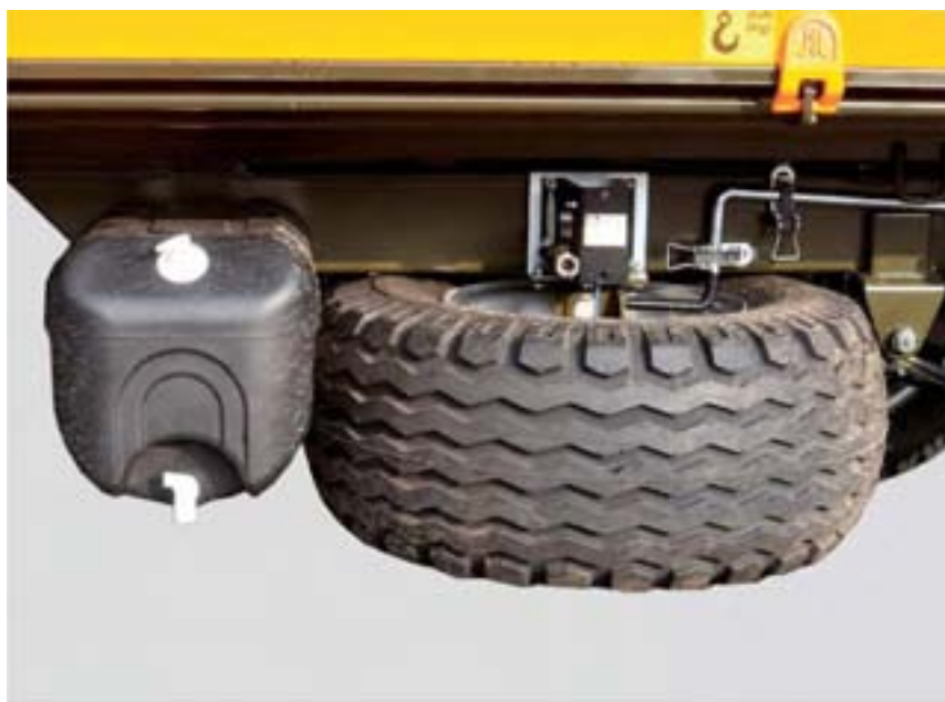
Фотография: Дополнительное оснащение прицепа РТ606: запасное колесо с лебедкой, установленное на раме шасси. Рядом контейнер для воды с емкостью для жидкого мыла.
