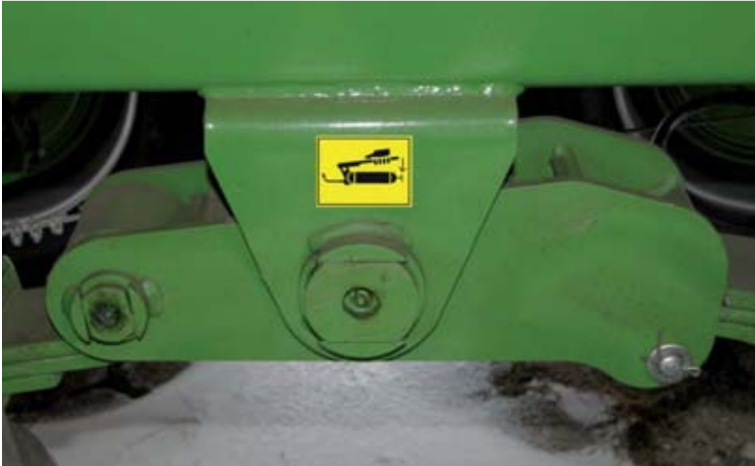
Фотография: При смазке необходимо помнить о труднодоступных местах. Все точки смазки подробно описаны в руководстве по эксплуатации
