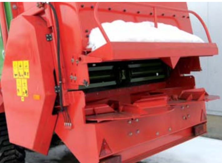
Фотография: Наиболее чувствительным элементом машины является разбрасывающая система, необходим тщательный осмотр системы редуктор-ось-диск
