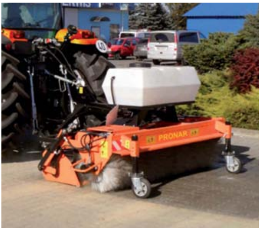
Фотография: Подметально-уборочная машина ZM-2000, установленная на задней СТН трактора
