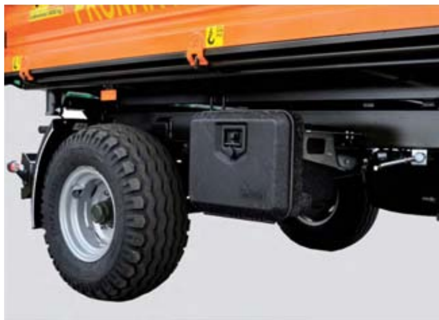
Фотография: Дополнительное оснащение прицепа PT606 для фиксации груза (например, поддонов) – ящик с инструментами.
