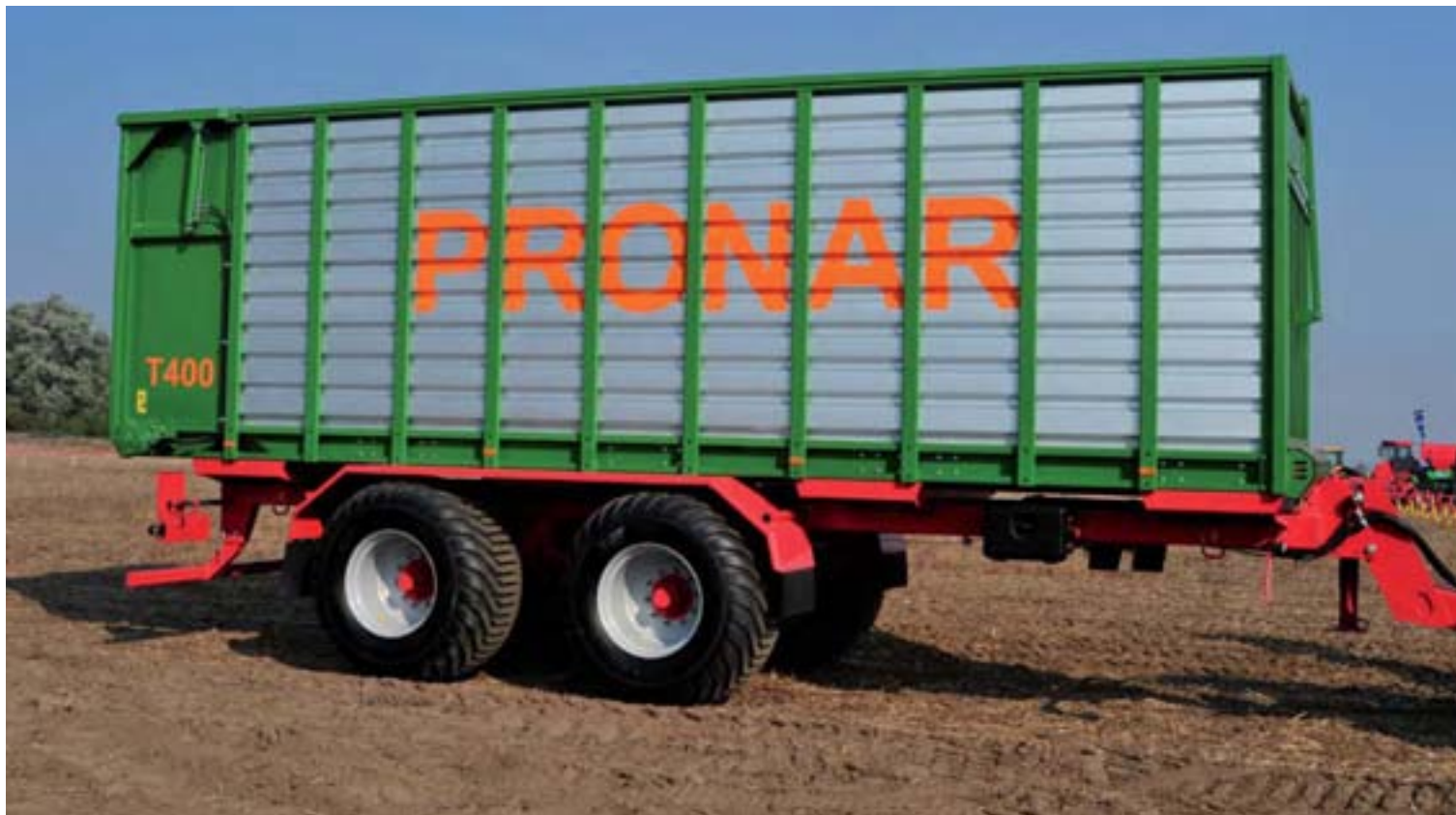
Фотография: Эффективная работа прицепа PRONAR T400 грузопместимостью 40 м 3 возможна при использовании трактора мощностью не менее 160 л. с.
