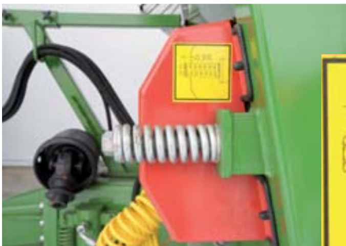
Фотография: Бесперебойная работа разбрасывателя зависит также от силы натяжения транспортировочной цепи
