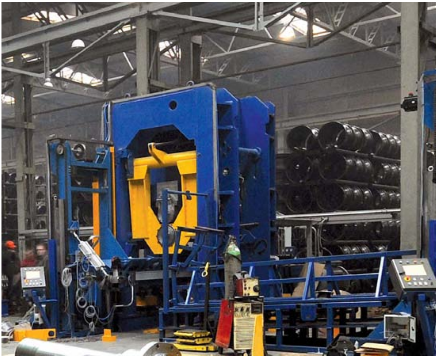
Фотография: Профилирующие станки линии MP7 во время запуска
