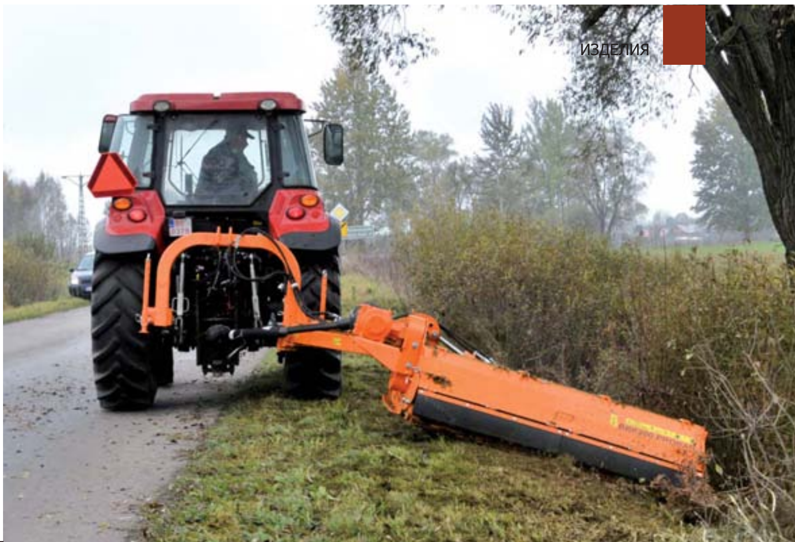
Фотография: Дисковая косилка с системой задней и боковой навески Pronar BVK200 во время кошения на обочинах
