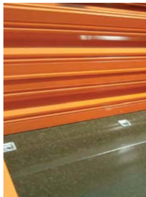
Фотография: Погрузочные захваты (8 шт.) прицепа PRO поддонов весом по 800 кг).
