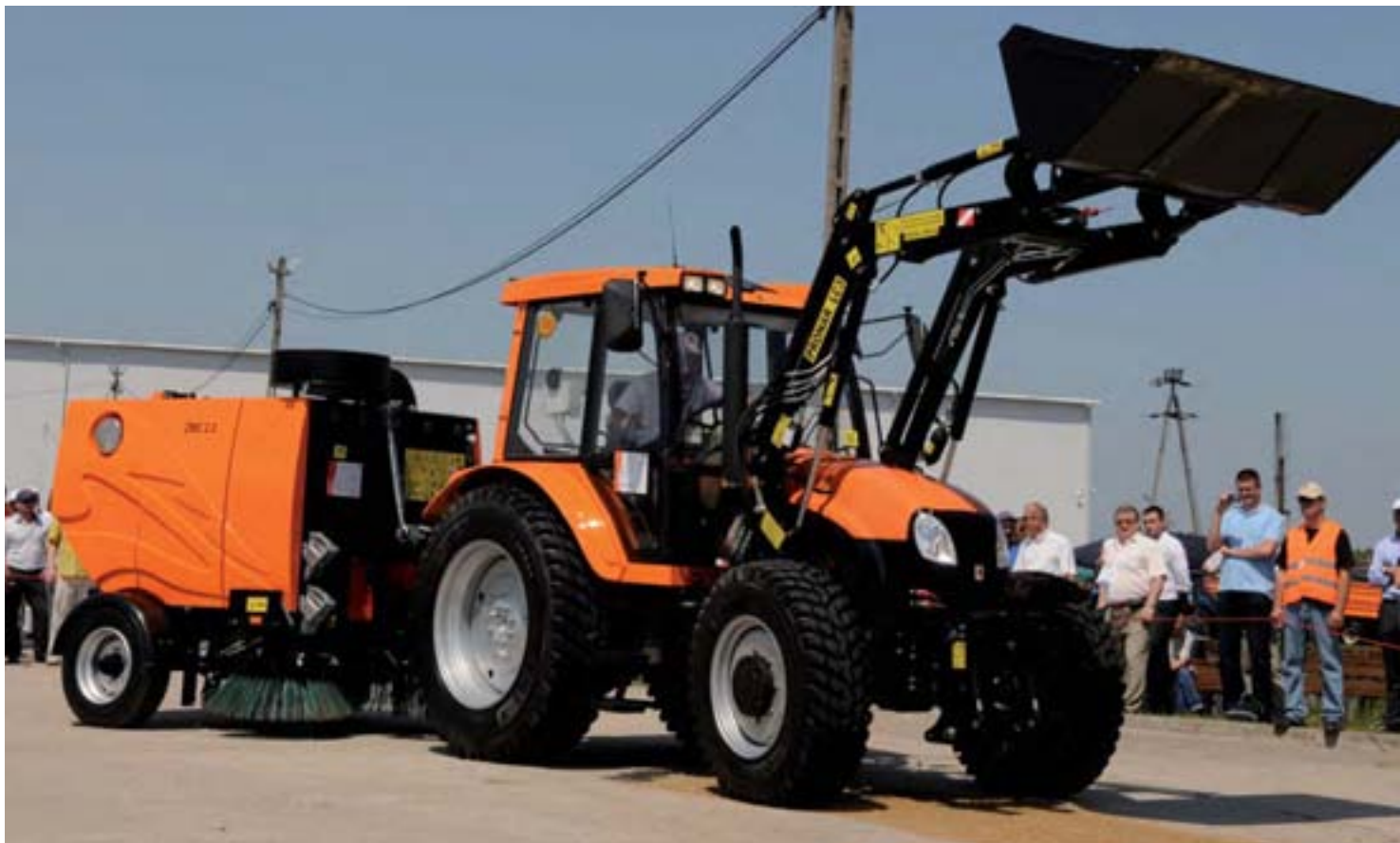
Фотография: Коммунальная версия Zefir 85 на дорожных колесах
