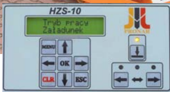
Панель управления пескоразбрасывателя PRONAR HZS10 - режим работы: погрузка
