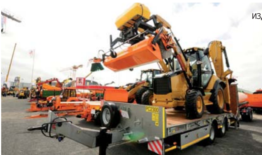
Система навески подметально-уборочной машины ZM 2000 позволяет агрегировать ее с экскаватором-погрузчиком CAT 432E
