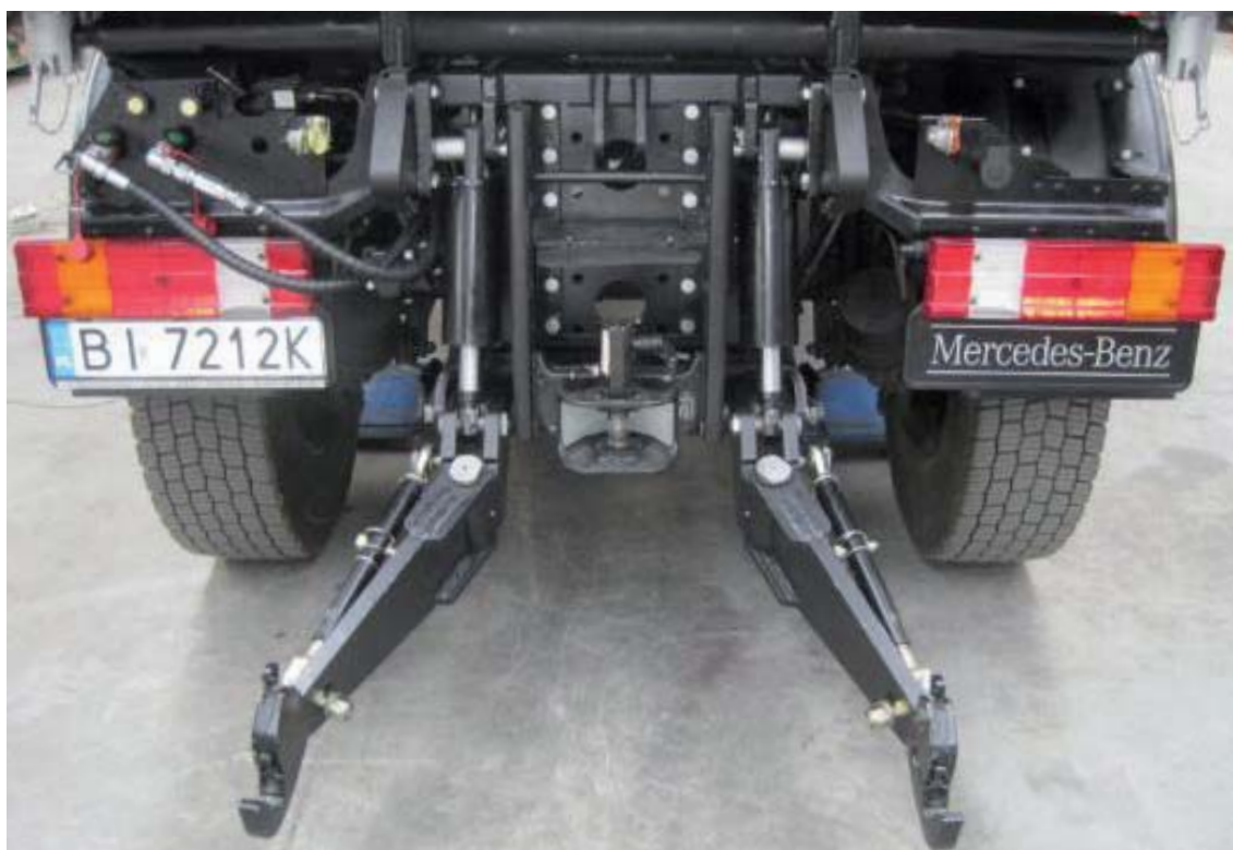
Задняя СТН с автоматическим транспортным крюком, установленном на носителе (Unimog U400)
