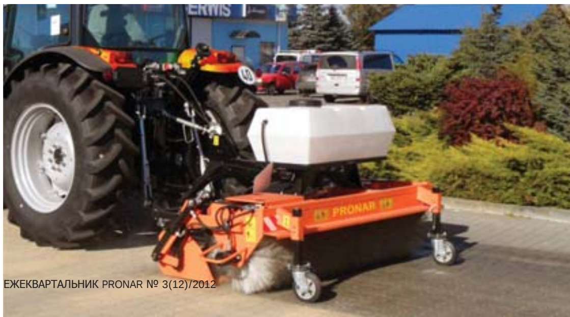
Подметально-уборочная машина ZM-2000, установленная на задней СТН коммунального трактора
