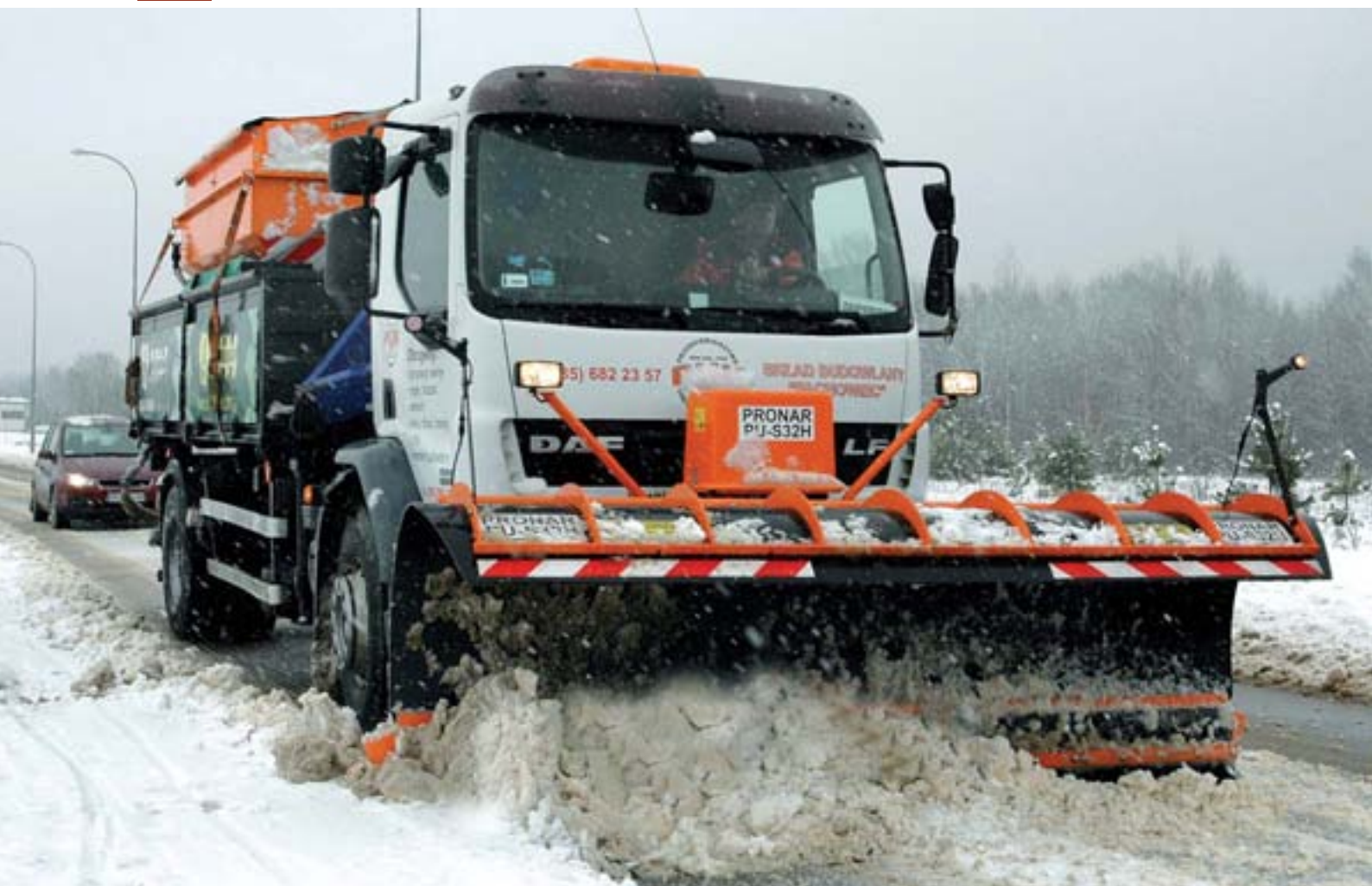
Снегоотвал PRONAR PU-S32H и пескоразбрасыватель PRONAR KPT40 в процессе выполнения работ по уходу за дорогами с зимний период
