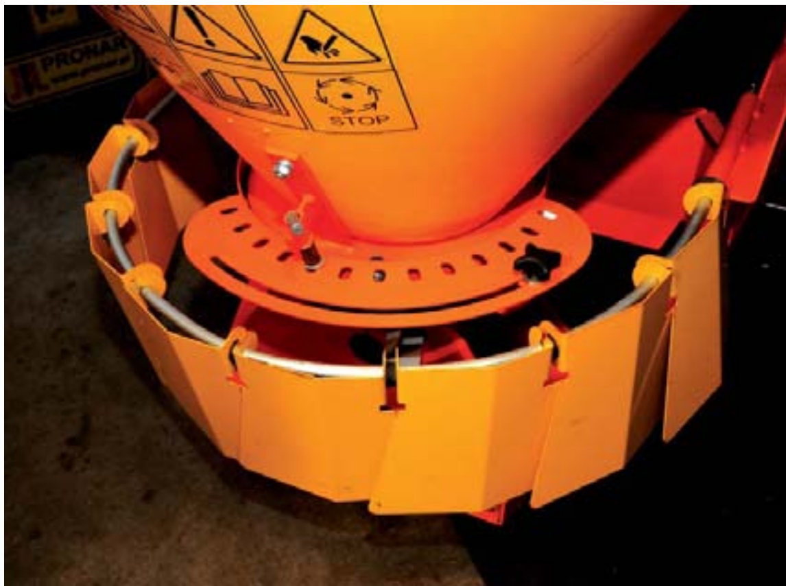
Пескоразбрасыватель PS-250 - дозирующая и разбрасывающая системы
