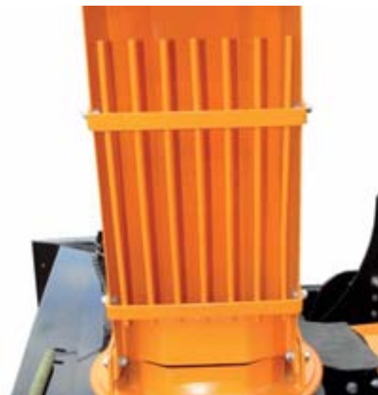
Кожух, защищающий от выброса глыб льда или камней
