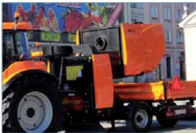
Опорожнение бункера подметально-уборочной машины ZMC 2.0
