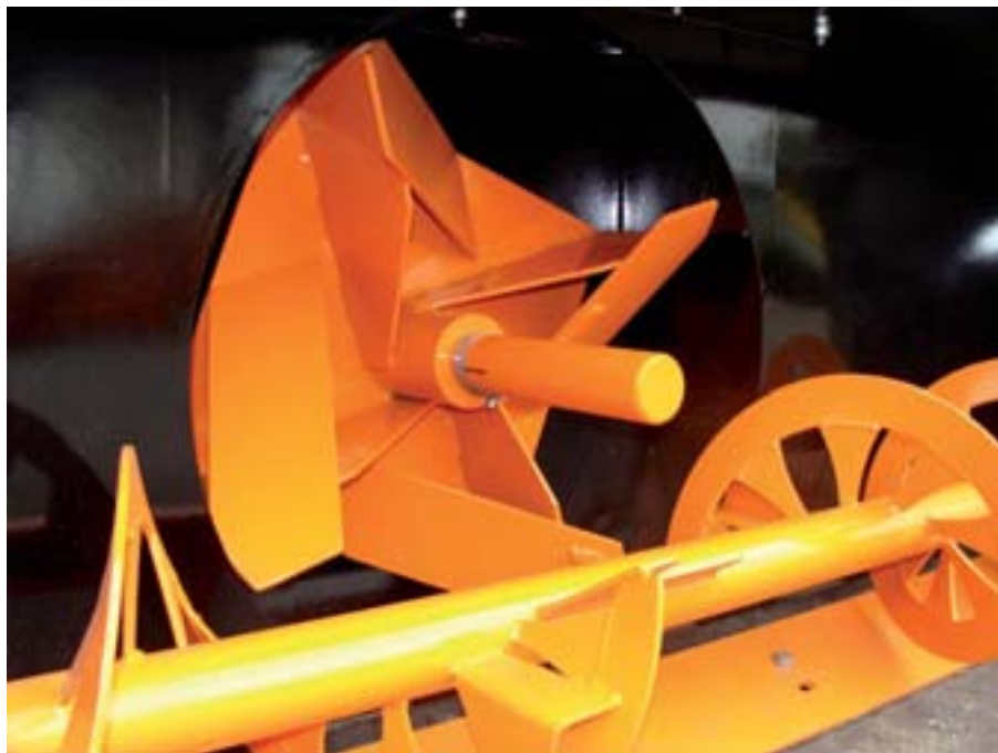
Лемех из износостойчивой стали, шнек, который измельчает, а также сгребаёт снег и лёд на ротор, а также ротор, подающий снег в трубу. Детали косилки выполнены из износостойчивой стали. Под цилиндрическим кожухом расположен конец вала для агрегирования с задней стороны трактора при движении вперед
