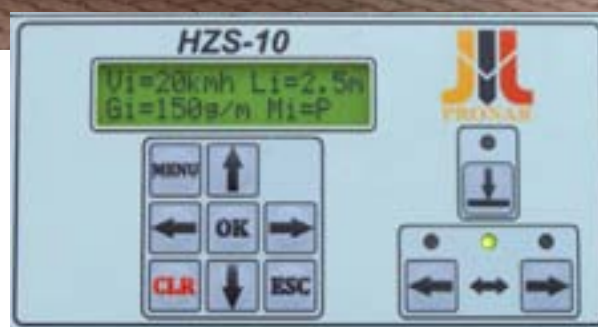
Панель управления пескоразбрасывателя PRONAR HZS10 с установленными параметрами посыпания
