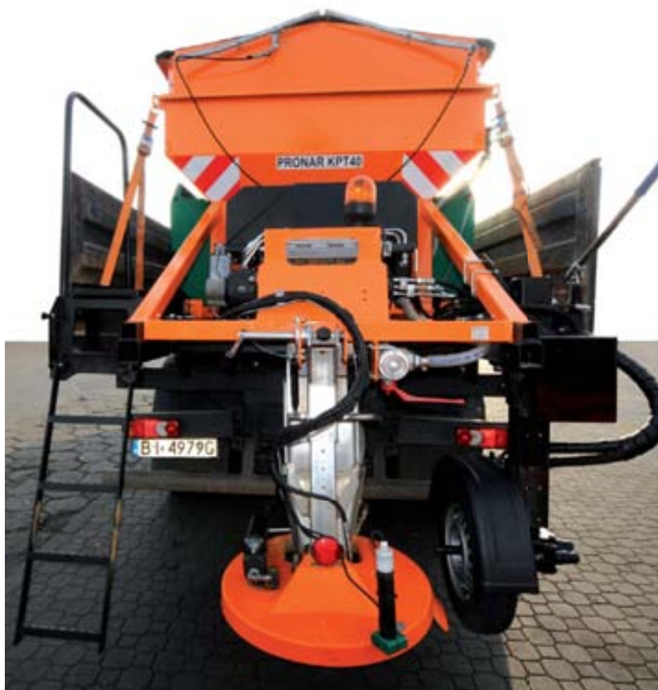
Элементы просеивающей системы, контактирующие с солью, изготовлены из нержавеющей стали в целях обеспечения длительного срока службы
