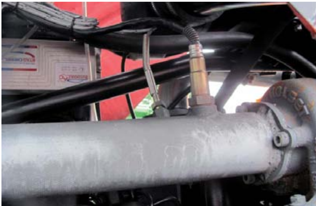
Датчик температуры выхлопных газов и лямбда-зонд на выхлопном коллекторе. На заднем плане: контроллер газа
