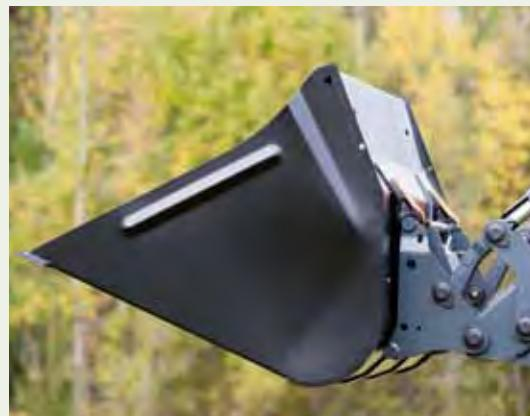
Ковш для легких материалов. Эта серия ковшей подходит для работы с зерном, семенами травы, щепой и другими материалами с низким объемным весом. Ковш имеет два вертикальных усиления в месте прикрепления крюков.
