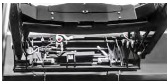
6 | ГИДРАВЛИЧЕСКИЙ ЗАМОК НАВЕСНОГО ОБОРУДОВАНИЯ Q LOCK.
