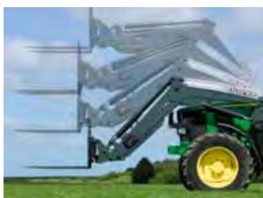
5 | Q LINK — ПАРАЛЛЕЛЬНОЕ ВЕДЕНИЕ.
