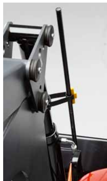
8 | ПРОСТОЙ ИНДИКАТОР НАВЕСНОГО ОБОРУДОВАНИЯ.
