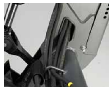
3 | НОВИНКА! ЗАЩИТА ШЛАНГОВ В КАНАЛЕ СТРЕЛЫ ПОГРУЗЧИКА.
