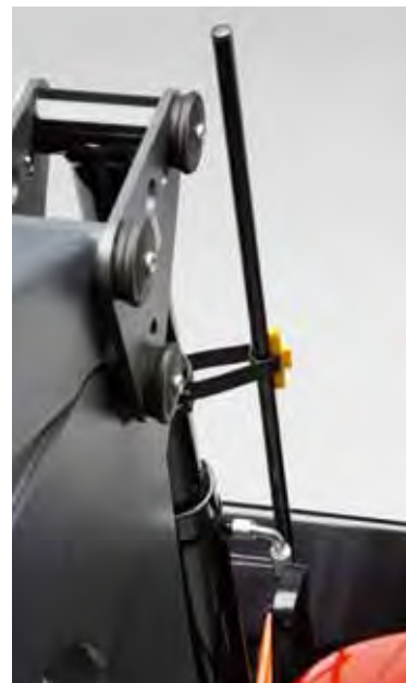
8 | ПРОСТОЙ ИНДИКАТОР НАВЕСНОГО ОБОРУДОВАНИЯ.
