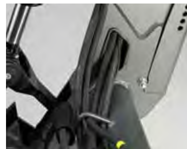
3 | НОВИНКА! ЗАЩИТА ШЛАНГОВ В КАНАЛЕ СТРЕЛЫ ПОГРУЗЧИКА.
