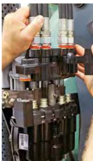
7 | МНОГОКОНТАКТНАЯ МУФТА MS4 – ВЕДУЩАЯ НА РЫНКЕ.
