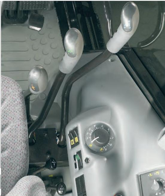
Тракторы серии А оснащаются полностью синхронизированной трансмиссией (12 передач переднего хода и 12 передач заднего хода) с механическим челночным механизмом. Трансмиссия имеет три диапазона, четыре основных передачи, а также оборудована ходоуменьшителем. КПД трансмиссии и силовой передачи чрезвычайно высок благодаря простоте конструкции.
