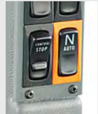
Valtras geniales AutoTraction-Feature gehört bei allen HiTech-Modellen der A-Serie zur Basisausstattung. Wenn Sie AutoTraction einschalten, können Sie den Traktor aus normaler Arbeitsgeschwindigkeit abbremsen, indem Sie einfach das Bremspedal treten oder den Fuß vom Gas nehmen. Sobald Sie das Bremspedal loslassen oder Gas geben, fährt der Traktor wieder an. Dabei sorgt die von Valtra entwickelte elektrohydrau-
