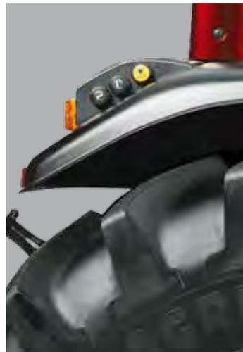
*An beiden Kotflügeln sind Schalter zum Heben und Senken des Krafthebers verbaut, um das Ankuppeln von Arbeitsgeräten zu vereinfachen (serienmäßig bei Valtra A HiTech, auf Wunsch auch Schalter für die Heckzapfwelle).*
